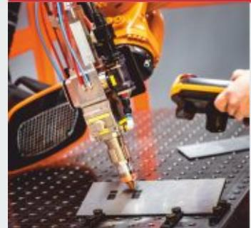
Установка плазменной горелки или лазерной головки дает практически неограниченные возможности резки. Благодаря превосходной кинематике робота можно выполнять снятие фаски любого типа для сварки, резку в готовых изделиях, таких как контейнеры, боковые стенки, готовые стальные конструкции.
