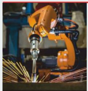
Сварочный держатель, установленный на плече робота, позволяет выполнять любые виды сварочных швов. Постоянная скорость и плавность движений выражаются в высоком качестве и эстетике сварного шва. Рабочий диапазон можно увеличить, поместив робота на дополнительную линейную ось.
