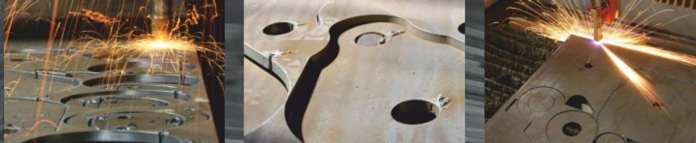
Новейшим решением в области плазменной резки являются агрегаты класса HD, в которых используется плазма высокой плотности (High Density), что непосредственно влияет на высокое качество резки (High Definition). Наиболее важным преимуществом технологии HD является минимальный рез, который позволяет точно делать отверстия и острые углы с минимальной фаской края (до 2%). Подходит для резки конструкционной стали, нержавеющей стали, кислотостойких материалов и алюминия.
