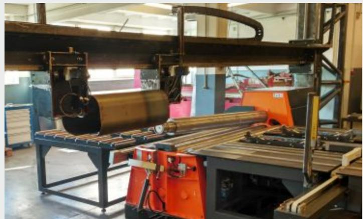
По специальному заказу нашего клиента мы спроектировали и изготовили линию для производства вентиляционных каналов большого сечения для атомных электростанций. Линия включает в себя: модуль подачи листов с максимальным форматом 2000 x 6000 мм и толщиной до 4 мм, вальцы, подготовленные для гибки специальной формы канала по проекту клиента, систему приема каналов с вальцов и специально разработанный для этой линии линейный сварочный станок.
