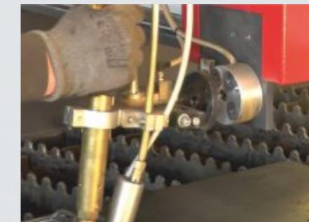
Специальная магнитная конструкция крепления защищает горелку при столкновении с выступающим или деформированным материалом. При обнаружении препятствия неодимовое гнездо освобождает инструмент, избегая дорогостоящих повреждений, а датчик столкновения немедленно останавливает станок. Дополнительным преимуществом крепления является возможность установки горелки в диапазоне +/- 45°. Это решение позволяет выполнять снятие фаски для сварки.
